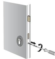
A continuación, introduce la llave en el cilindro desde el interior de la puerta y gírala ligeramente hasta alinear la leva con el cilindro. Extrae el cilindro deslizando hacia afuera. Si te cuesta extraerlo, prueba a aflojar los tornillos de la manilla/roseta interna.
